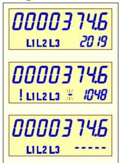
Jeweils obere Zeile: Energiewert (hier mit einer Nachkommastelle) in kWh Untere Zeile rechts: Summe der Momentleistungen der Phasen L1, L2, L3, mindestens eine liegt oberhalb der Anlaufschwelle
