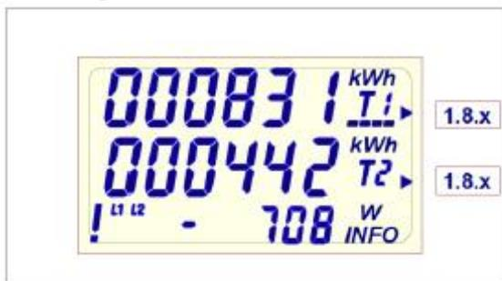
Spannungsausfall einer Phase
